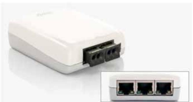
Die WebFiber Lichtleiter-Switches sind für die professionelle Hausinstallation vorgesehen. Sie dienen dazu, den Datenstrom von RJ45-LAN-Kabeln in ein oder mehrere separate optische Signale umzuwandeln. Durch die modulare Bauweise können bis zu zwölf Anschlüsse für Lichtleiter zur Verfügung gestellt werden.
